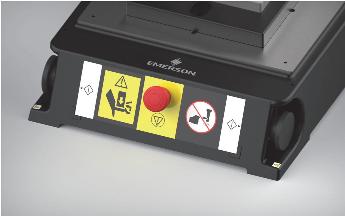
Abbildung 1.5 Sicherheitsetiketten auf der Grundplatte
