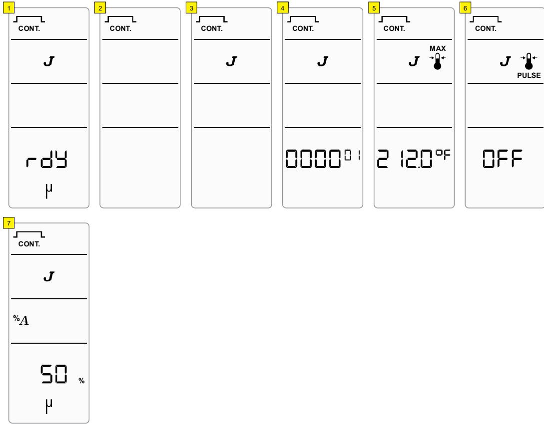
图 6.14 温度限值 - 连续超声波（能量）模式
