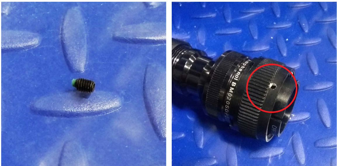
图 2.5 螺丝 / 射频连接器
