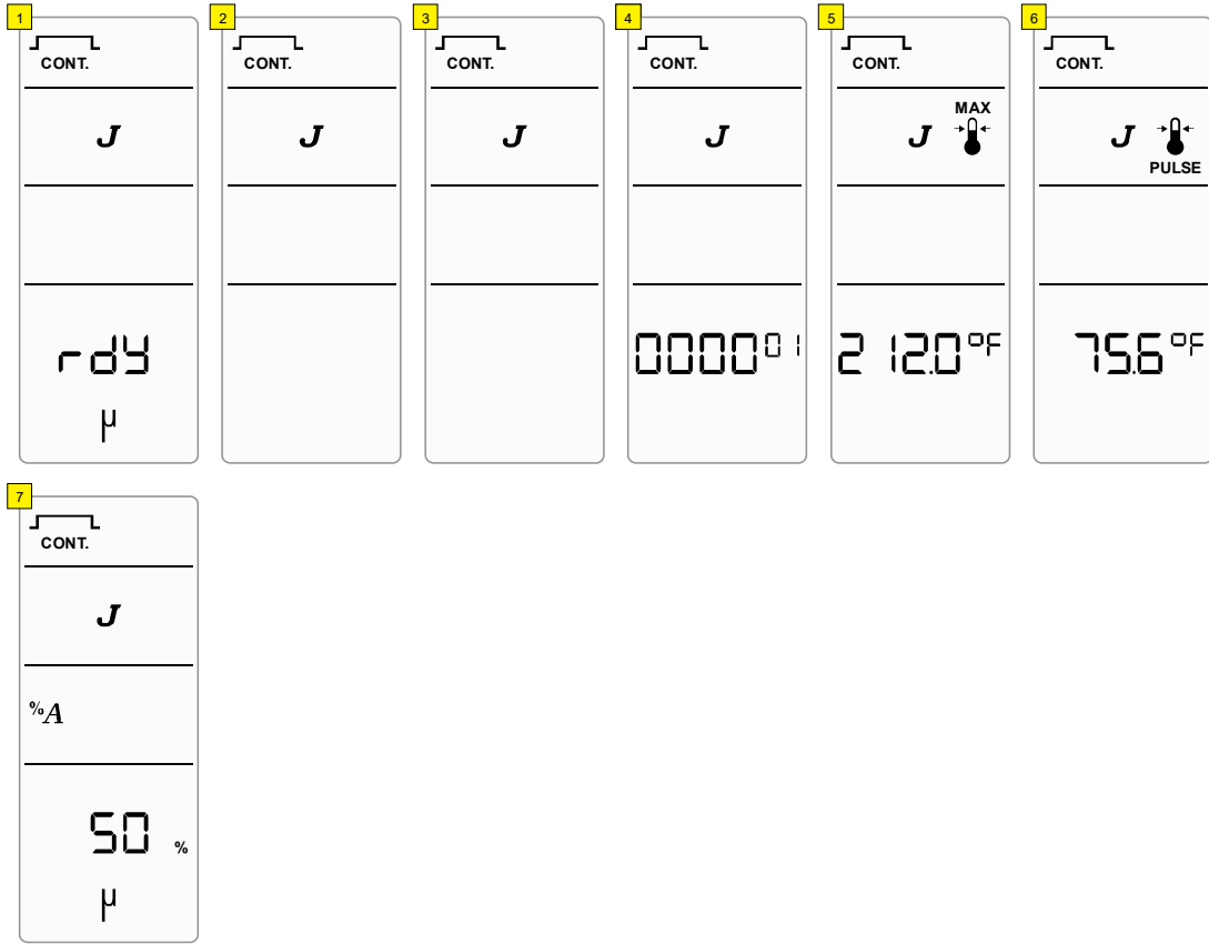
图 6.18 脉冲温度 - 连续超声波（能量）模式
