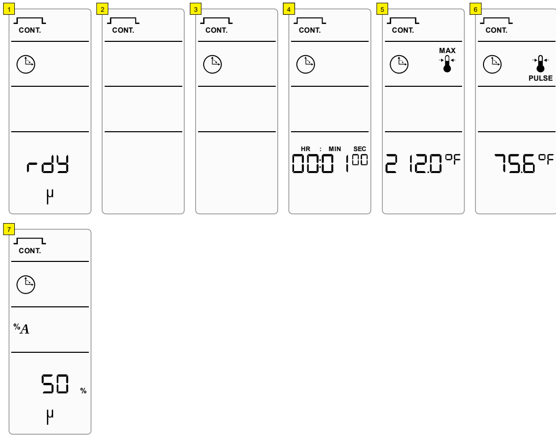
图 6.17 脉冲温度 - 连续超声波（时间）模式
