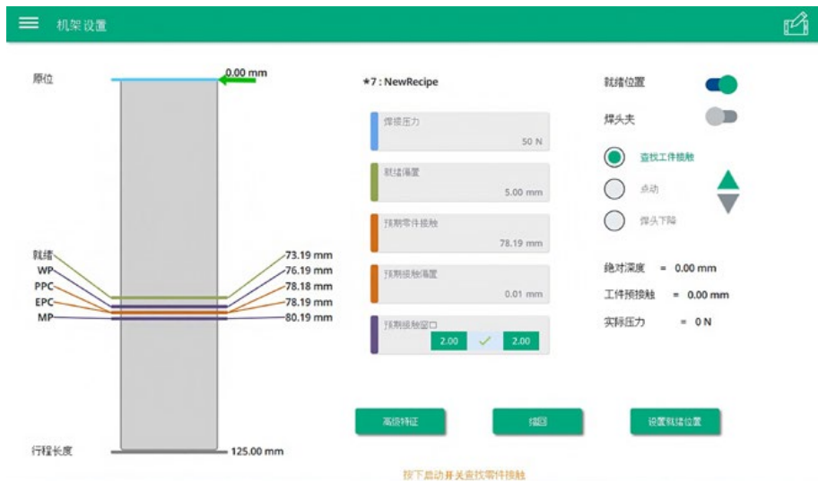
图2:就绪位置最小为5mm,即下降和返回行程为5mm,从而大幅度减少焊头下降和返回时间。
