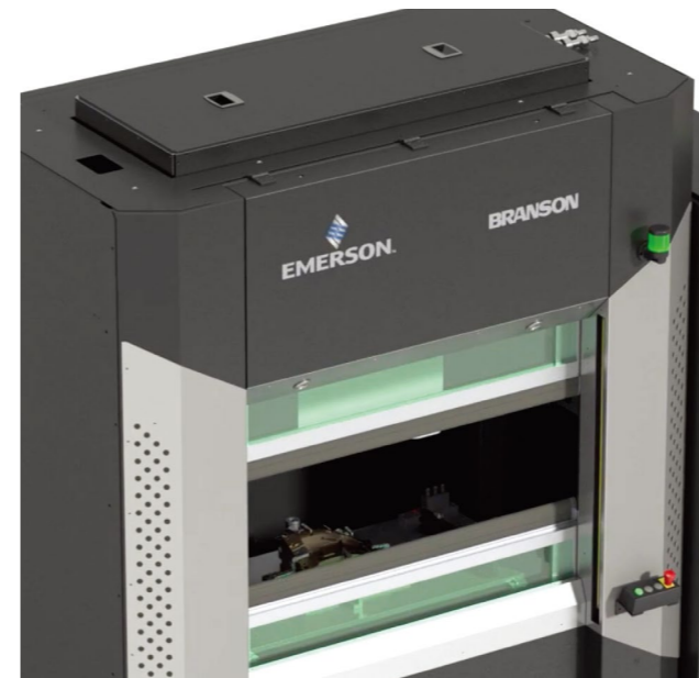
GLX标配内置光栅和安全隔离带。
