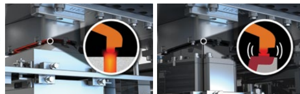
Fonctionnement de la technologie de soudure propre par vibration
