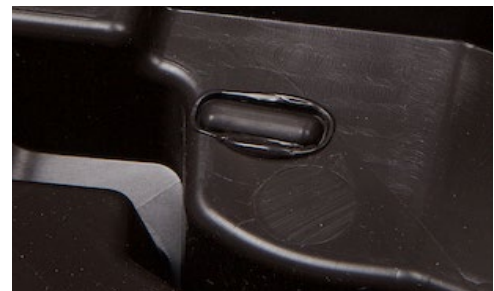
Superficie de la nervadura después del remachado
