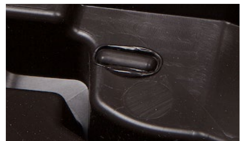
Nervure de surface après rivetage
