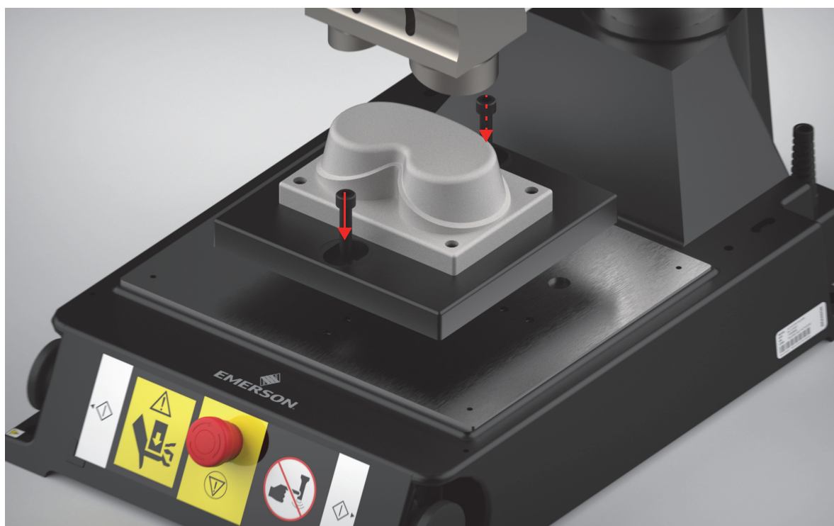
Figura 4.23 Montaje del alojamiento de pieza en la base - Columna redonda
