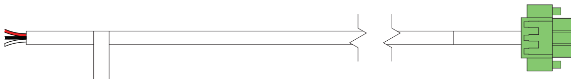
Figura 4.13 Cable de Detección de Contacto a Tierra
