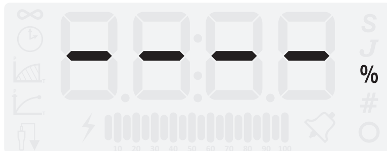
Figura 7.2 Pantalla LCD en modo de control de amplitud externo
