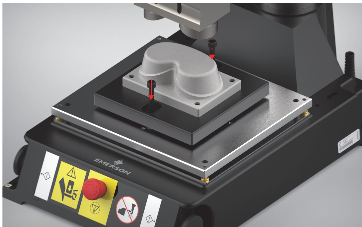
Figure 4.26 Montage du posage sur la plaque de mise à niveau
