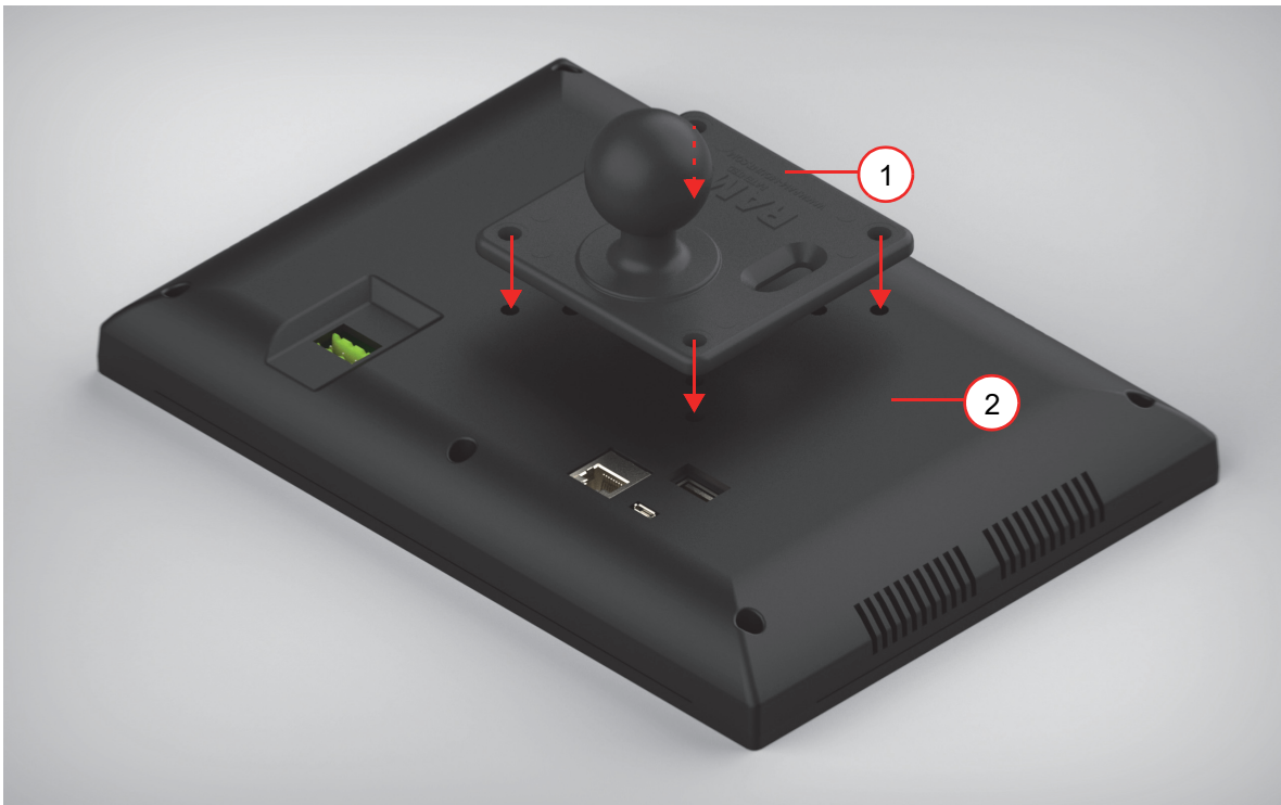
Figure 5.18 Fixation de l'IHM à la plaque de montage
