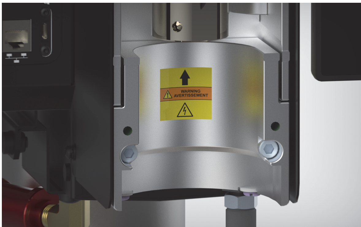
Figura 1.4 Etichette di sicurezza all'interno dell'attuatore
