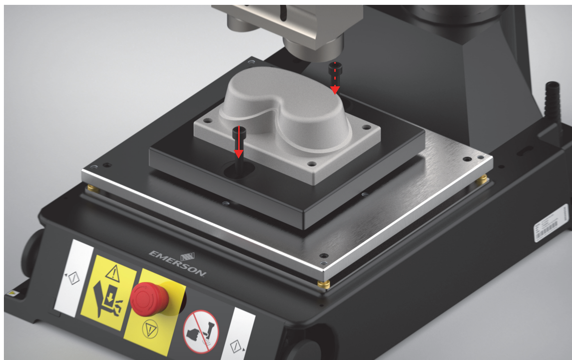
Figura 4.27 Montaggio del posaggio sulla piastra di livellamento
