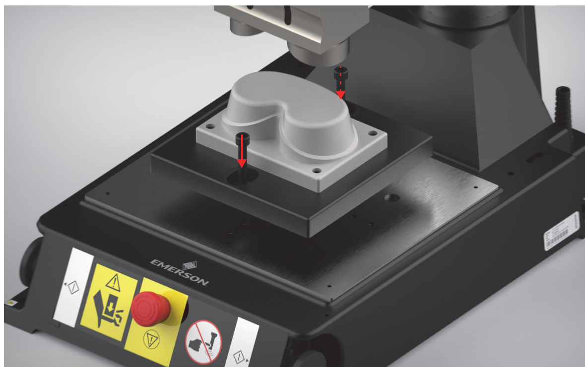
Figura 4.24 Montaggio del posaggio sulla base - Colonna rotonda
