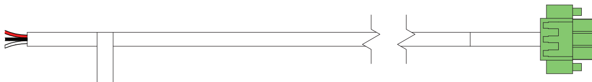
Figura 4.13 Cavo Rilevazione Contatto Di Terra
