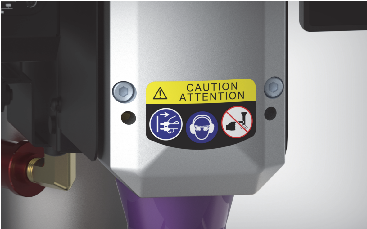
Figura 1.3 Etichette di sicurezza sulla parte anteriore dell'attuatore
