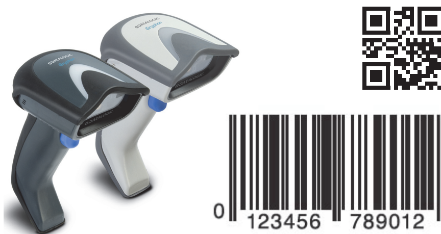
Figura 4.32 Esempio di lettore di codici a barre, codice a barre lineare 1D e codice a barre 2D
