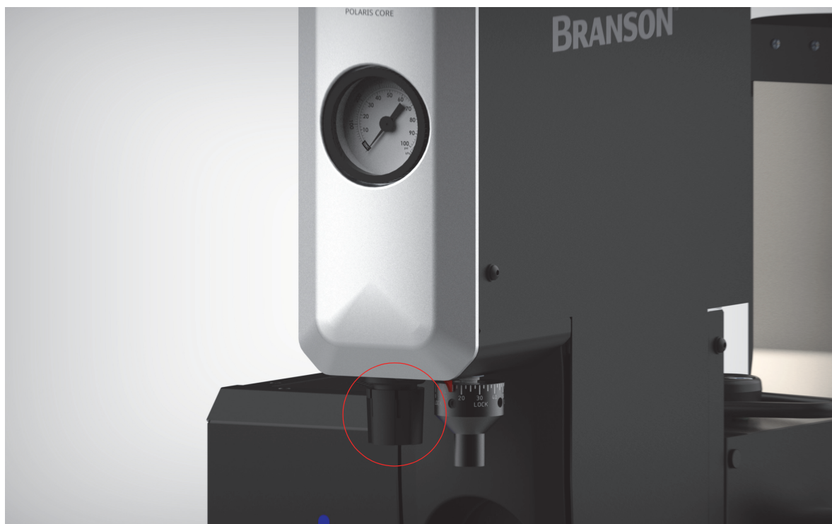
Figura 5.3 Pressione dell'aria regolata e indicatore della pressione dell'aria
