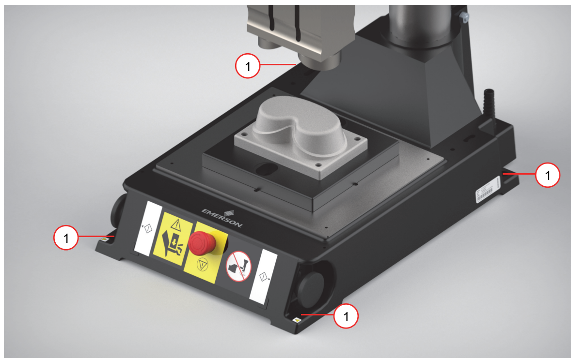
Figura 4.3 Colonna rotonda - Interassi di montaggio della base
